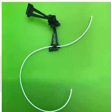
Les tubes montés. Insérez-les à fond dans les trous afin d'éviter le blocage du filament à son passage.
