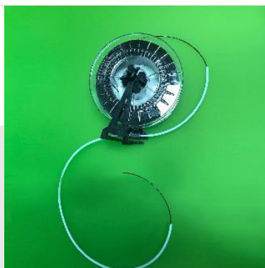
Passez le filament tout au long des tubes. Si celui-ci bloque à la jonction, enfoncez bien les tubes à fond.
